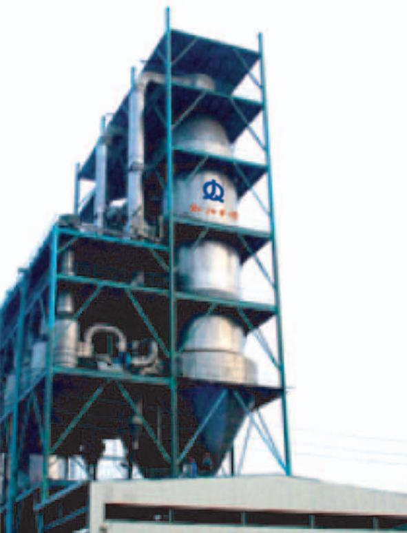
气流式喷雾干燥流程根据工艺的需要可分为两种，一种是上喷式，即喷嘴设置在干燥塔的顶部，雾化后的料液和热风从上向下并流完成干燥过程，适合于粘度较大且具有一定热敏性物料的干燥；第二种是喷嘴设置在干燥塔的底部，雾化后的料液和热风一起从下向上完成干燥过程，适合于耐温性能较好的物料的干燥。传统的小规模的减水剂的干燥原来都采用这种方式。气流式喷雾干燥机的雾化器，也叫气流式喷嘴，喷嘴结构一般较为简单，低粘度物料和高粘度料液均可雾化，使用范围较广，所得的颗粒较细，一般约为5~30微米，操作弹性大。但其缺点也很明显，就是用于雾化的压缩空气的动力消耗较大。主要用于高粘度料液或分子量较大的有机料液的雾化干燥。气流式喷嘴根据结构可分二流体和三流体，其中二流体又可分为外混式和内混式两种。
